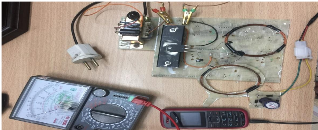
Hình 2.2: Sạc điện thoại không dây đã chế tạo
