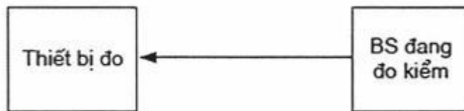
Hình D.2 - Sơ đồ đo tần số RF, công suất mã và điều chế phát
