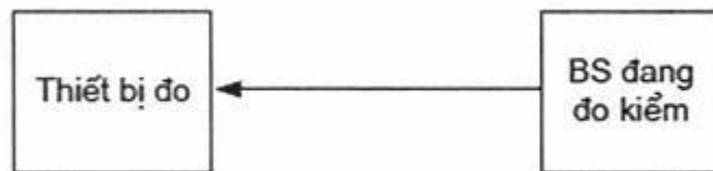
Hình D.1 - Sơ đồ đo phát xạ ngoài băng
