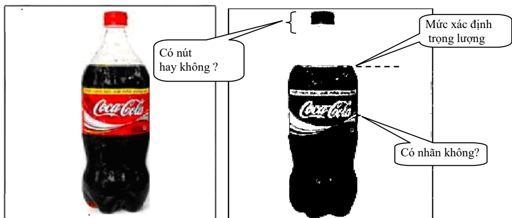
Hình 2. 4. Phân ngưỡng để có ảnh nhị phân và các vị trí kiểm tra trên ảnh
