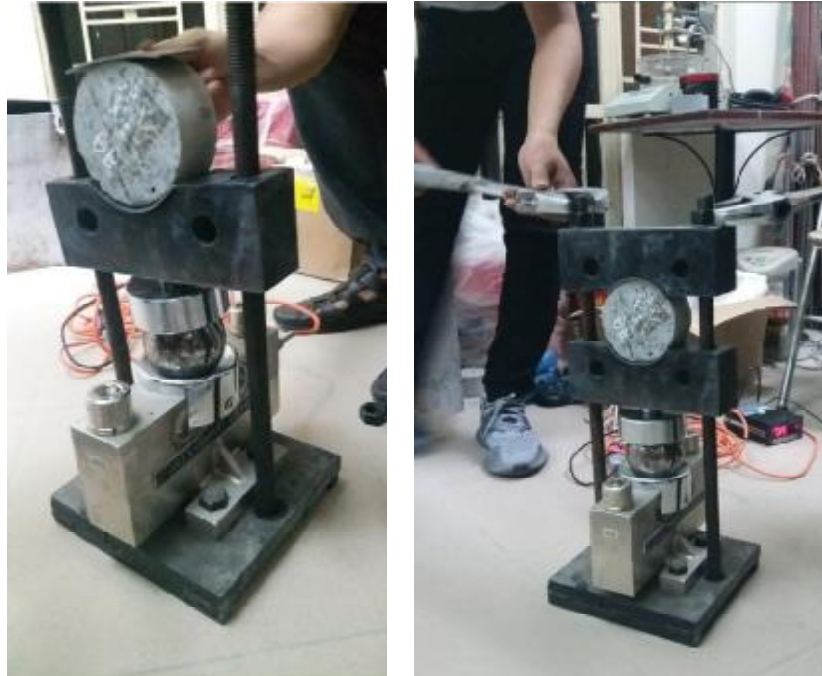
Hình 3.9 - Lắp đặt khung gia tải
