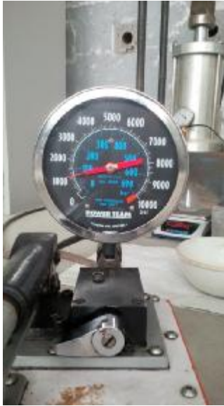
Hình 2.14 - Đồng hồ đo áp lực nén của tải trọng và áp lực nước vào
