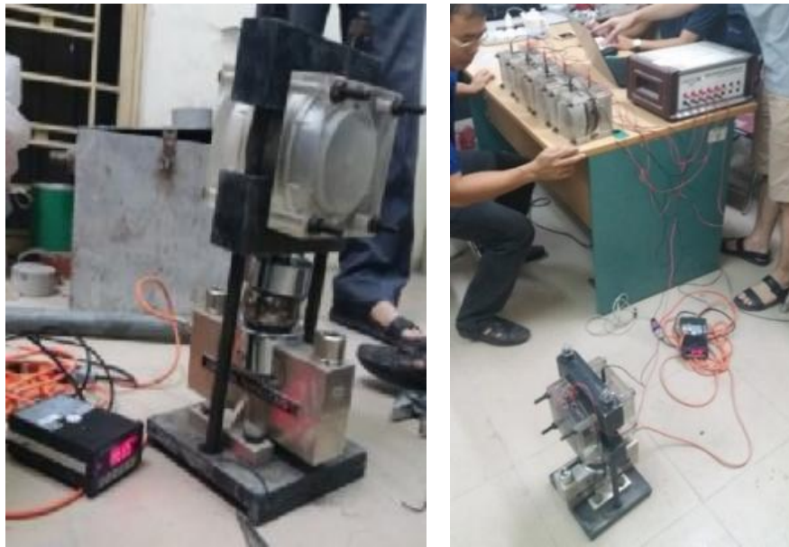
Hình 3.10 - Kết nối máy đo điện lượng với máy tính
