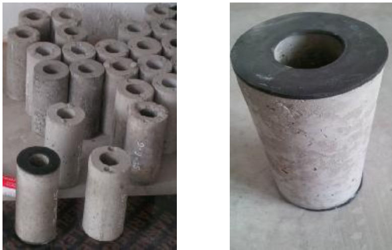
Hình 2.11 - Đúc và gia công các mẫu thí nghiệm đo thấm nước của bê tông chịu tải trọng nén trực tiếp
