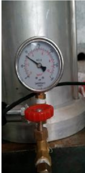
Hình 2.14 - Đồng hồ đo áp lực nén của tải trọng và áp lực nước vào
