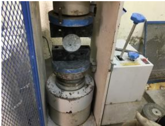
Hình 3.7 – Thí nghiệm nén xác định tải trọng lớn nhất gây phá hủy mẫu
