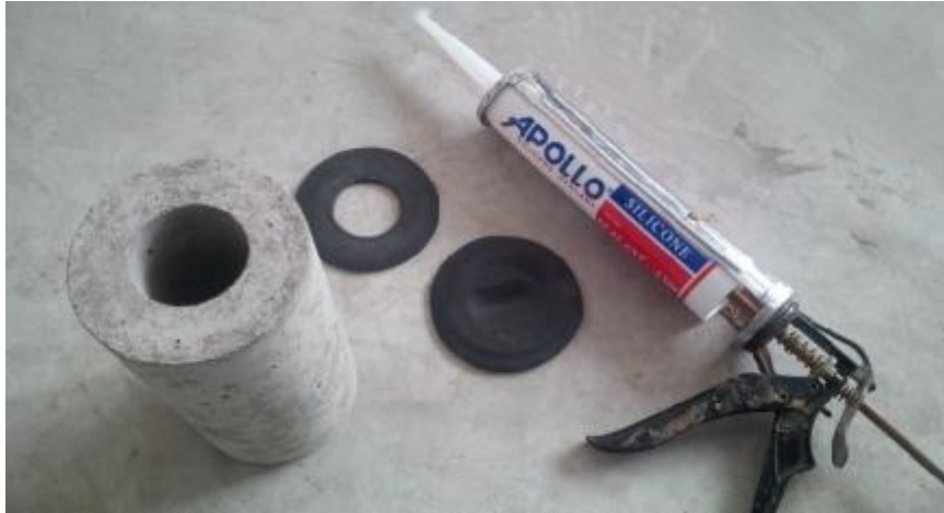
Hình 2.12 - Xử lý hai đầu mẫu bằng tấm đệm cao su và silicone
