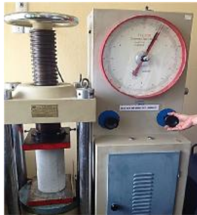
Hình 2.7 - Nén trước các mẫu với các cấp tải trọng khác nhau
