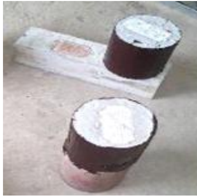
Hình 2.8 - Mẫu thử được cắt ra từ các mẫu trụ đã được gia tải theo các cấp tải trọng khác nhau và được xử lý chống thấm mặt bên
