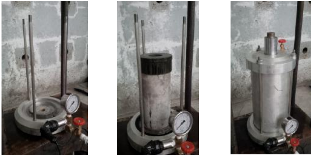
Hình 2.13 – Buồng đo thấm nước mẫu bê tông chịu tải trọng trực tiếp
