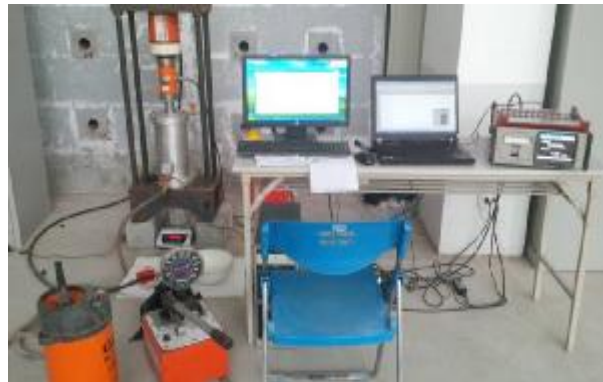
Hình 2.17 - Toàn cảnh bố trí thiết bị đo độ thấm nước của bê tông chịu tải trọng nén trực tiếp
