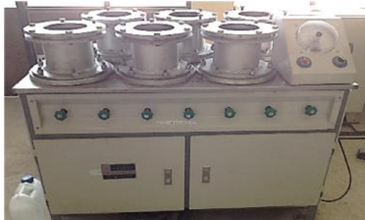
Hình 2.5 - Thiết bị xác định độ chống thấm nước của bê tông (HS – 40)
