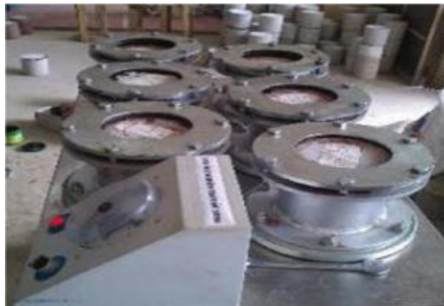
Hình 2.9 - Lắp mẫu thử vào máy thử thấm
