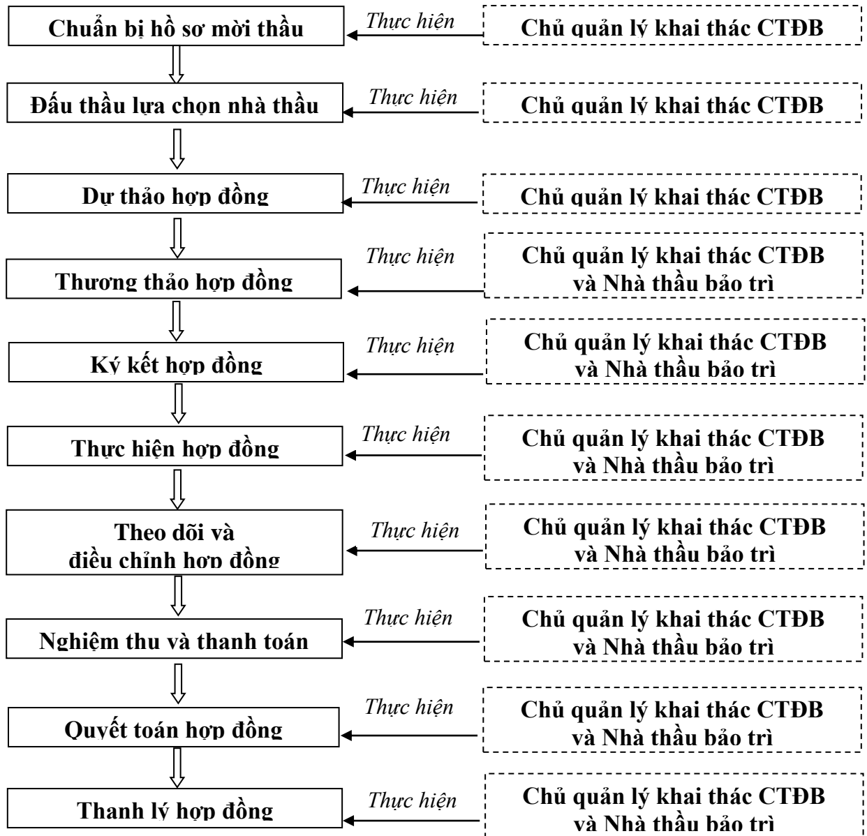
Hình 2.7 – Quy trình quản lý hợp đồng bảo trì công trình đường bộ điển hình
