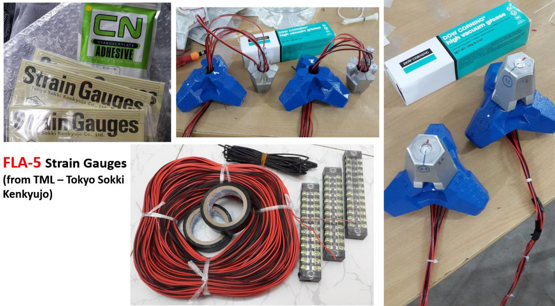
Hình A.9 Các cảm biến điện trở FLA-5 cùng keo dán chuyên dụng CN của hãng Tokyo Sokki Kenkyujo (Nhật Bản) và hệ thống dây dẫn & keo phủ chống nước
