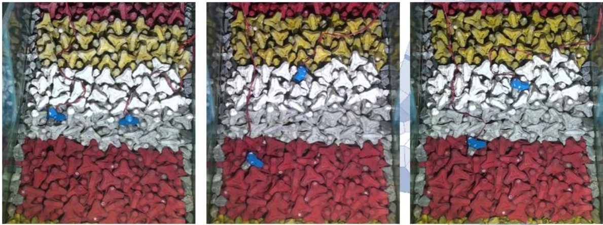
Hình 2.11 Các vị trí đo trên mái trong 3 trường hợp: ngang mức nước (a), trên dưới mực nước một khoảng H_s (b) và trên dưới mực nước một khoảng 0,5H_s (c)
