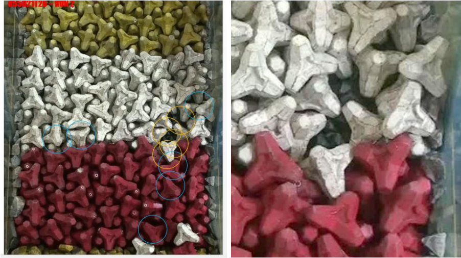
Hình 3.7 Phân lớp giữa bị lộ ra dưới tác động của sóng trong trường hợp hư hỏng nghiêm trọng nhất
