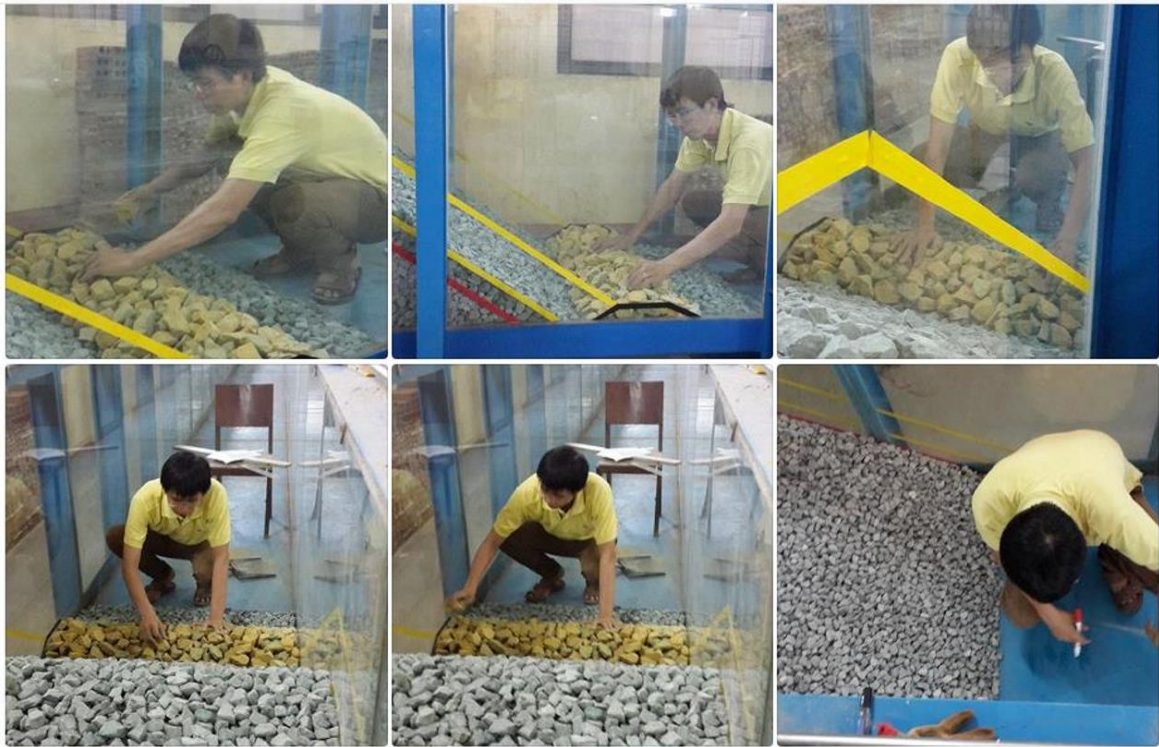
Hình A.6 Xây dựng mặt cắt đê thí nghiệm trong máng sóng
