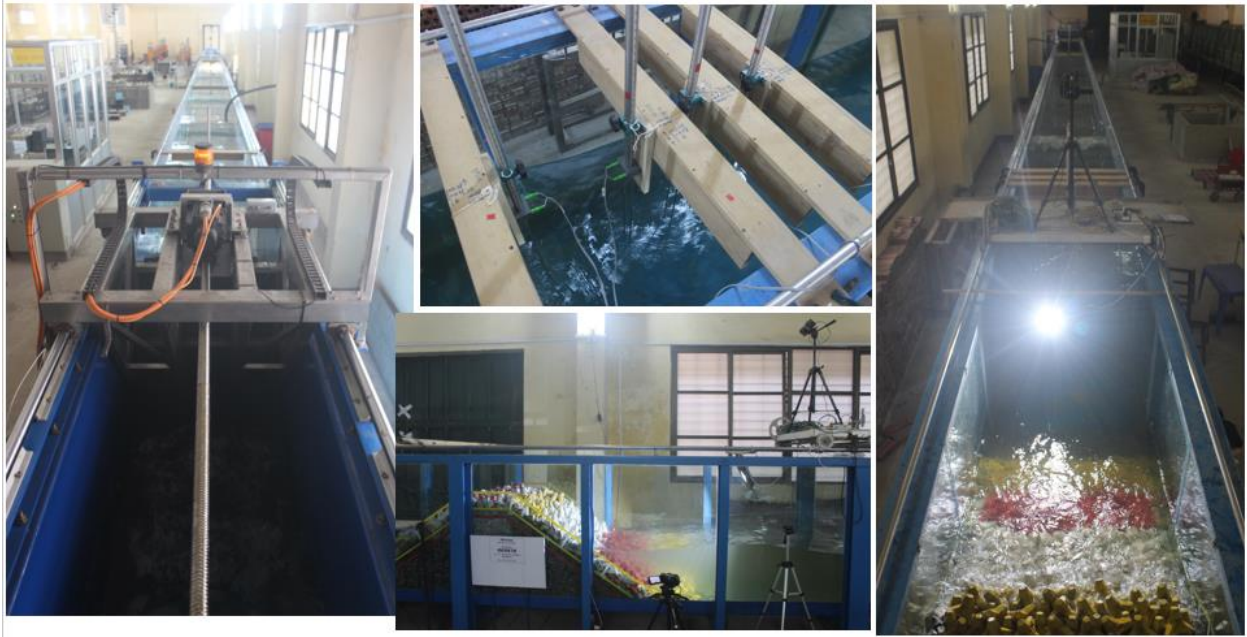
Hình A.3 Bố trí các thiết bị phục vụ thí nghiệm trong máng sóng Hà Lan
