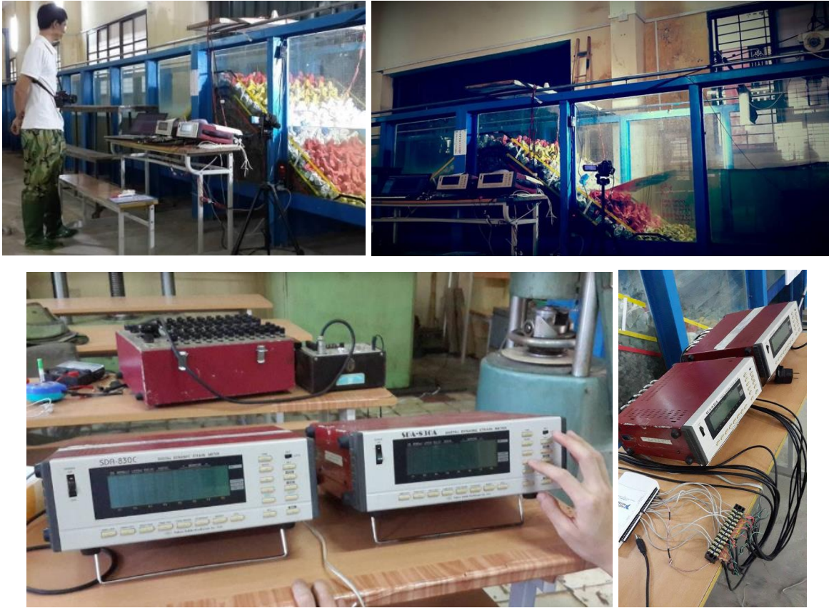
Hình A.12 Các máy đo động SDA-830A và SDA-830C được sử dụng trong thí nghiệm độ bền kết cấu của khối phủ RAKUNA-IV
