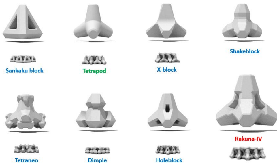
Hình 1.11 Các dạng khối phủ cải tiến với hình dạng tứ diện đều đẳng hướng [20]
