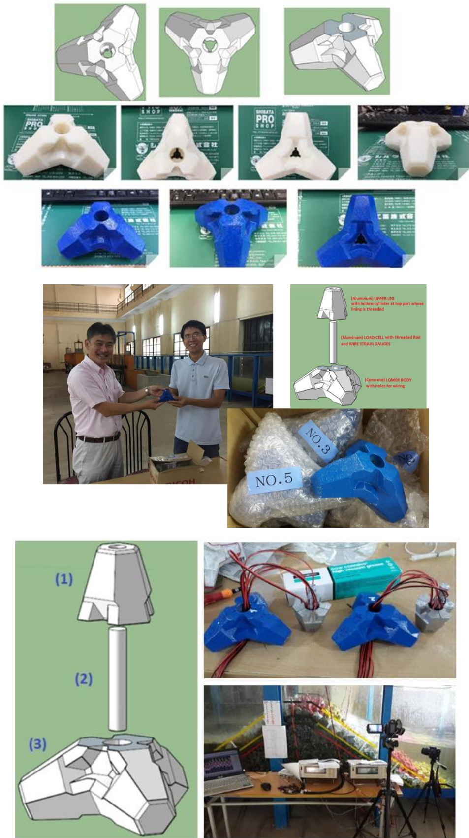
Hình A.8 Thiết kế các mô hình thí nghiệm cho khối phủ có gắn cảm biến (i-RAK) và bố trí thí nghiệm độ bền kết cấu
