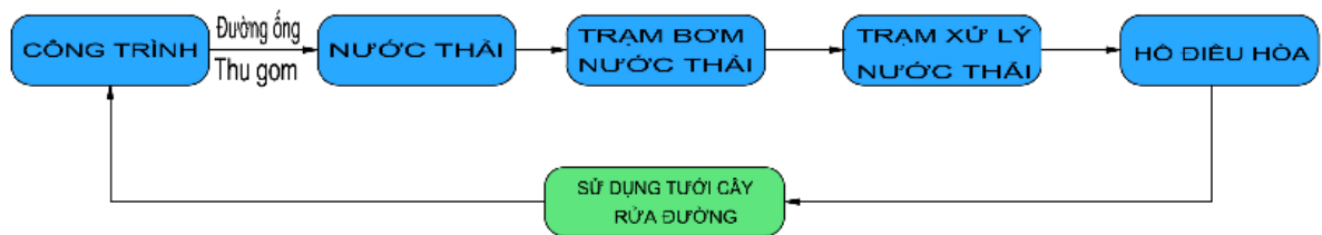
Hình 3.12. Sơ đồ xử lý nước thải theo mô hình tuần hoàn.
