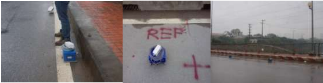
Hình 3.15. Bố trí thiết bị đo dao động trên mặt cầu.
