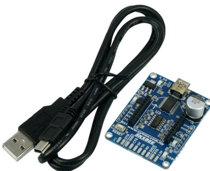
Hình 4.9 : Bộ cấu hình cho Xbee
